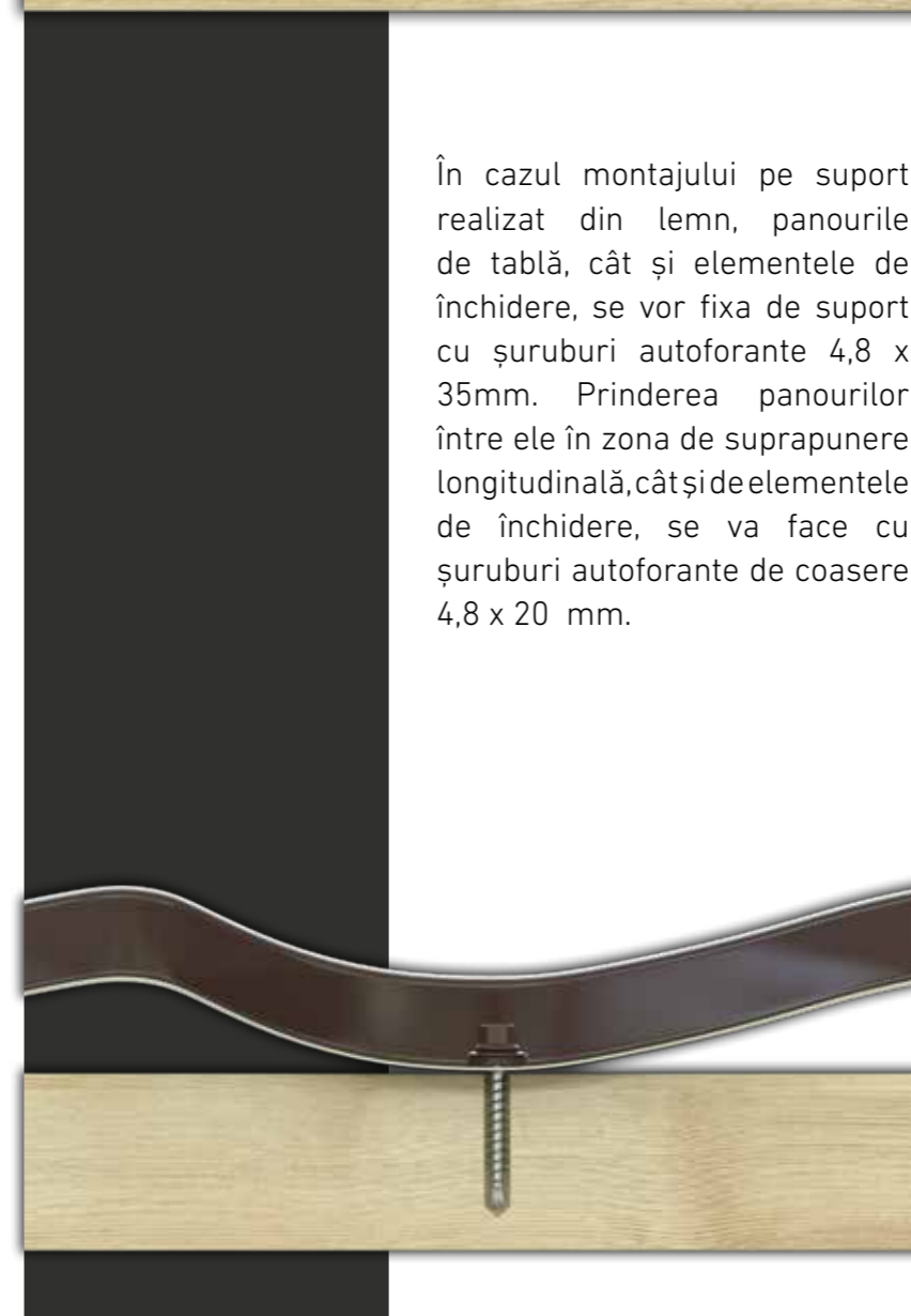
Șurub coasere (metal-metal) 4,8 x 20 mm
